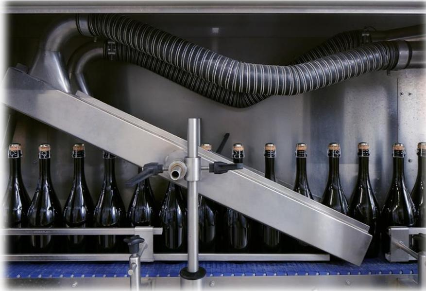
bottiglie/ora di vino fermo e 4000 bottiglie/ora di vino spumante. Dotata di una riempitrice a 40 rubinetti, il complesso viene gestito da un sistema software che permette un automatismo in sinergia con la microfiltrazione e garantisce un passaggio fondamentale per la perfetta qualità del vino e la sua shelf-life.
